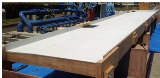
旧建設省土木研究所の模型実験に準拠して制作された、排水試験装置（※日之出水道機器㈱による。）
